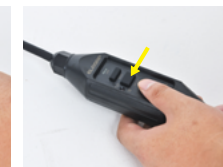
4. Stiskněte tlačítko «RE-SET», kontrolka se rozsvítí červeně. RCD funguje správně.
